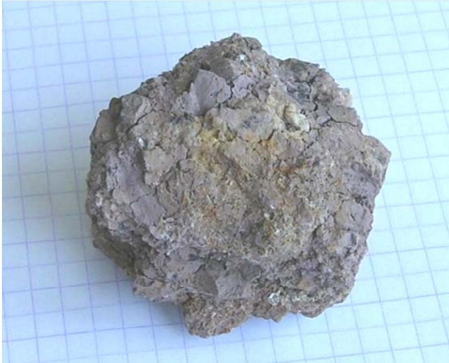
Figure 108. Bloc d'argile de la couche étudiée dans ce chapitre (puits p1, 1,1-1,3m de profondeur)
