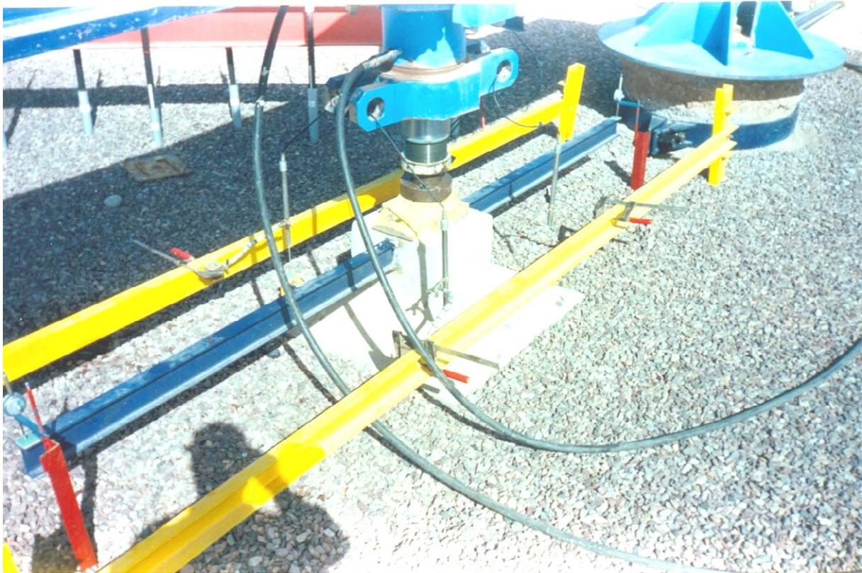
Figure 156. Systèmes de mesure des tassements des fondations pendant les essais
