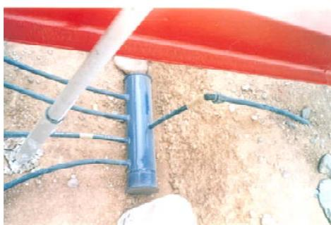
Figure 159. Alimentation en eau des deux tubes
