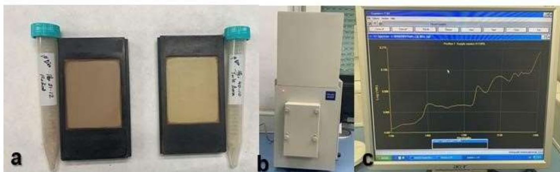
Figura 4. Cápsulas de medición en el NIRS (a), equipo de NIRS (b) y espectro de absorbancia a todas las longitudes de ondas para una muestra (c).
