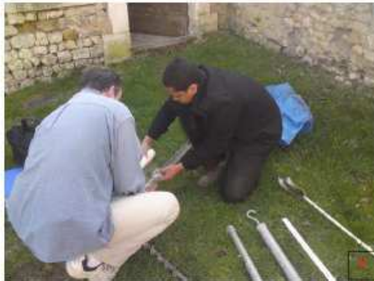
5600 Figure 49. Déroulement du prélèvement d'un échantillon du sol. 1. prélever l'échantillon de 10 kg du sol par la tarière thermique. 2. placer le sol prélevé à la tarière dans un demi-tube en PVC pour reconstituer un log approximatif et emballer avec un film plastique transparent.
