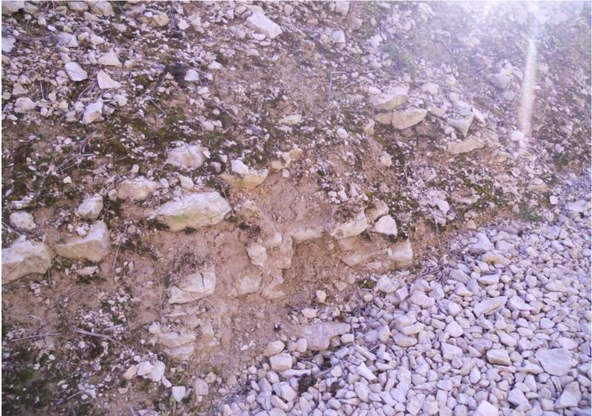
Figure 20. Profil du talus du versant en face du site pilote. Des bancs de calcaire stratifiés et fragmentés (J9).
