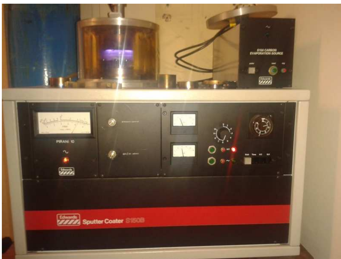
Photo 1. Appareil de métallisation des échantillons du sol au Cnam.
