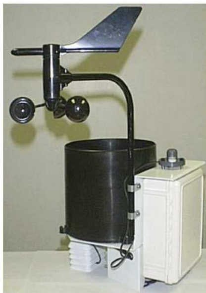
Figure 43. La station météo WatchDog 2900ET mise en place sur la parcelle du site pilote.
