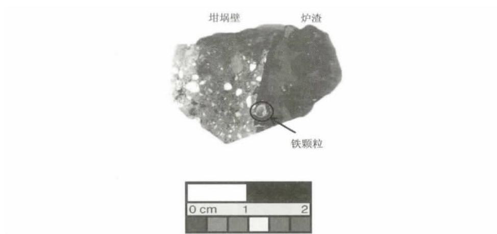
图6 燕川炼铅坩埚局部剖面照片 在炉渣接近坩埚一侧可以观察到一个铁颗粒(标尺总长2厘米)
