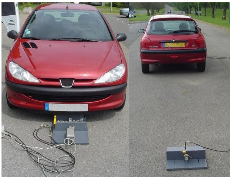
Figure 130 : Vue de l'implantation et du positionnement de l'émetteur et du récepteur.
