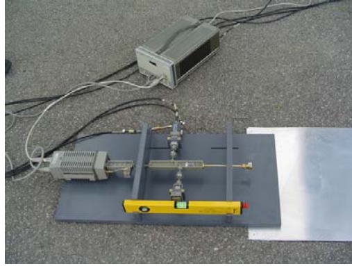
Figure 132 : Vue de la partie émettrice équipée d'un pointeur laser.
