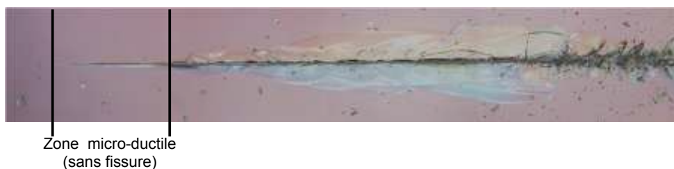
FIGURE 1.6 : Déformations permanentes lors d'un essai de rayage sur un verre à vitre recuit avec une charge croissante de 3 N sur 3 mm, [LE HOUÉROU et al. , 2003].
