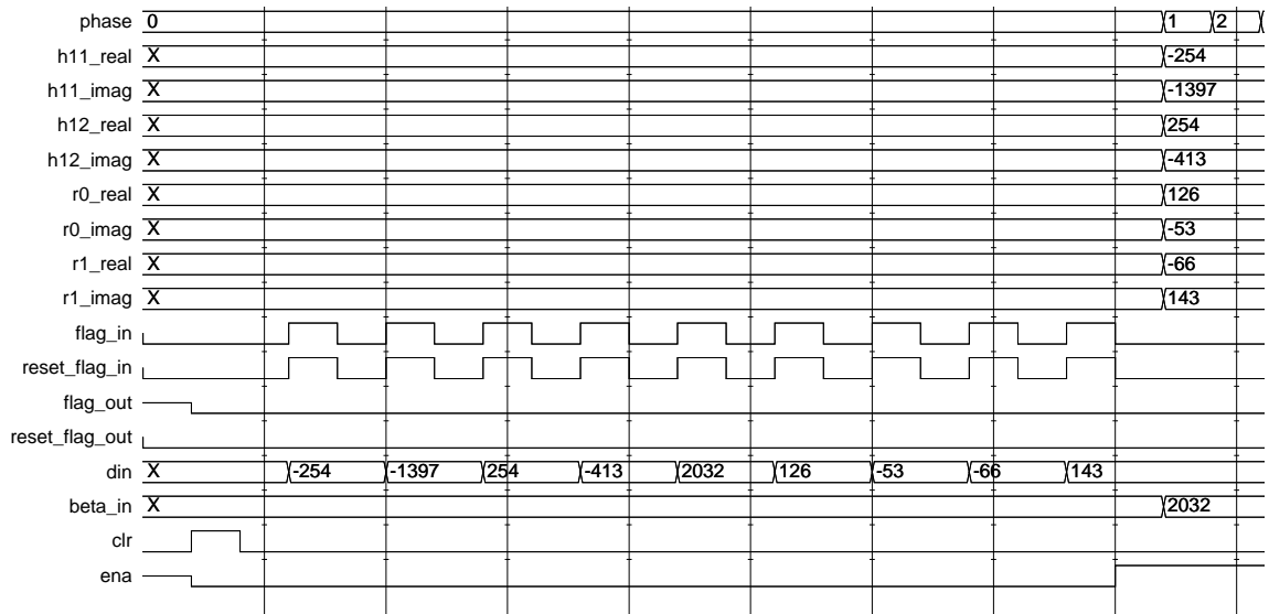
FIG. D.4 – Chronogramme des signaux en entrée du décodeur V-BLAST
