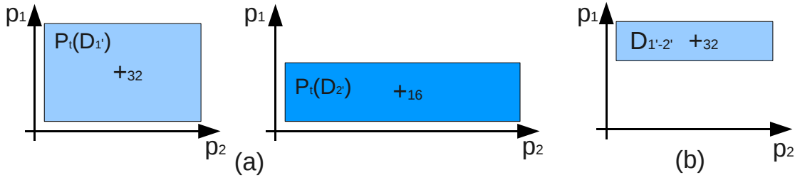
FIG. 3.5: Deux projections de domaines ( \mathcal{D}'_1 et \mathcal{D}'_2 ) sur l'espace des processeurs (a) et leur différence (b)
