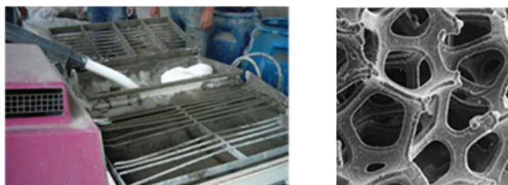
Figure 4. 4a : Ajout de mousse dans la chambre de gâchage d'un malaxeur, 4b : Mousse obtenue par dépôt sur une matrice support (données : www.recemat.nl )
