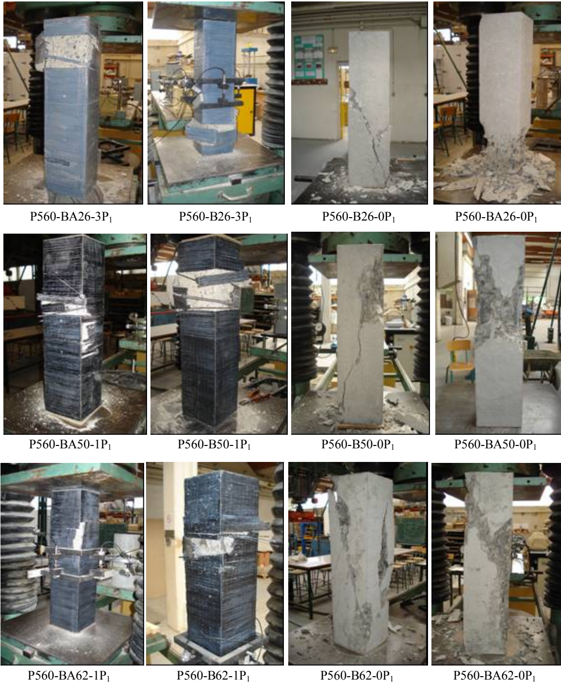
Figure II.3. 16: Mode de rupture des spécimens (140x140x560 mm) confinés avec des matériaux composites «PRFC»
