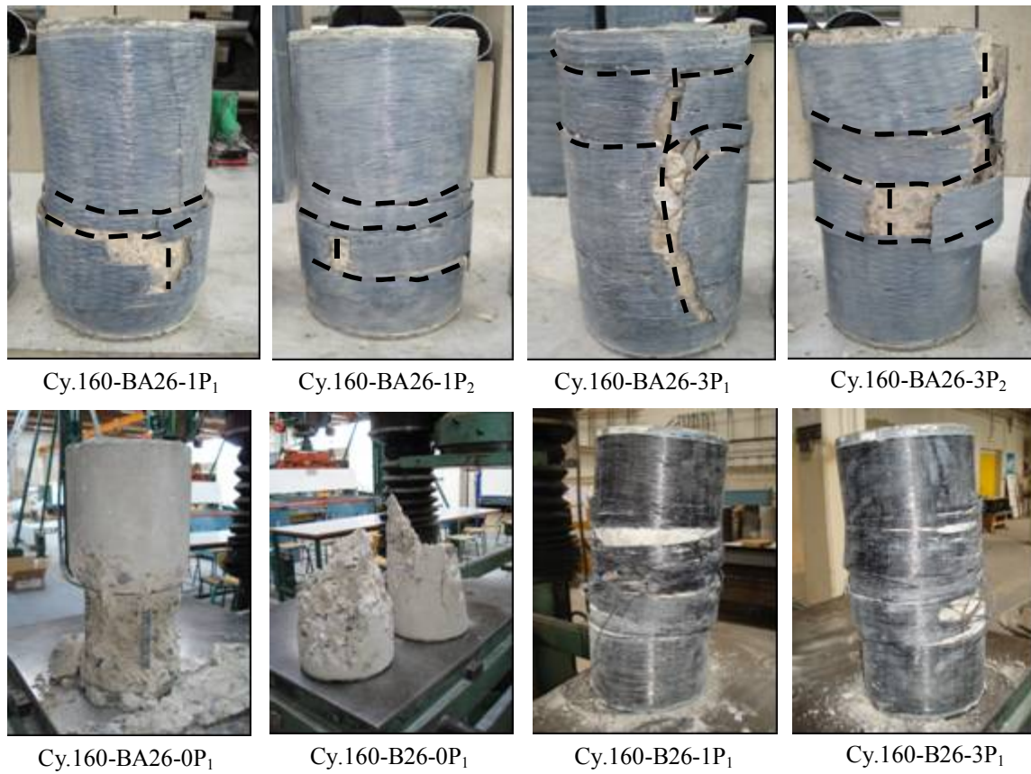
Figure II.3. 13: Mode de rupture des éprouvettes cylindriques confinées avec des matériaux composites PRFC (série 1)
