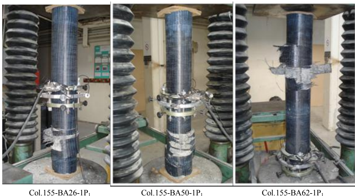
Figure II.3. 18: Mode de rupture des colonnes ( \text{\O}155 \times 1000 mm) confinées avec des matériaux composites «PRFC»
