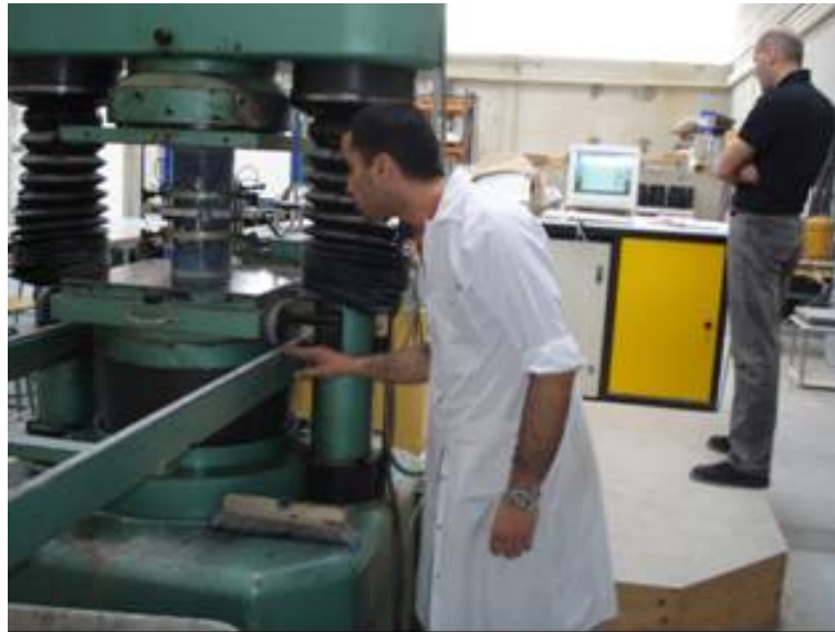
Figure II.2. 6: Presse hydraulique et système d'acquisition automatique de données
