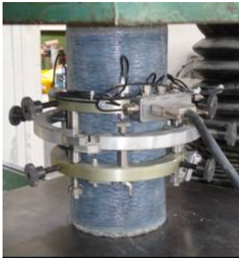
(a) extensomètre circulaire
