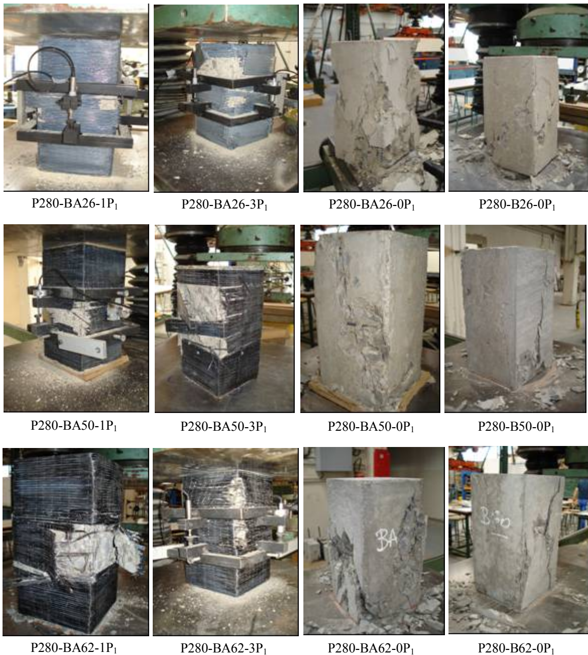
Figure II.3. 15: Mode de rupture des spécimens (140x140x280 mm) confinés avec des matériaux composites «PRFC»
