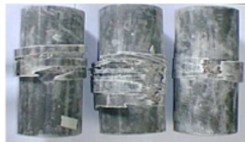
Cylindres en béton confiné par 3 couches PRFV
