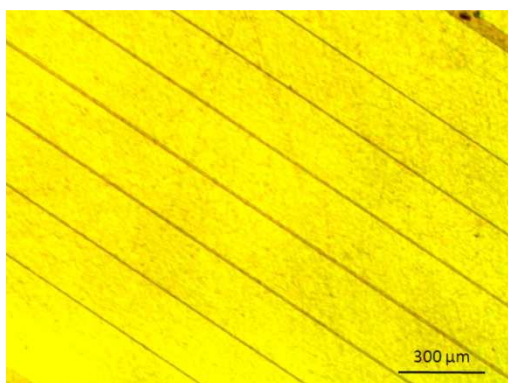
Figure 44 : Etat du masque de silice observé au microscope optique après échange ionique (x5).
