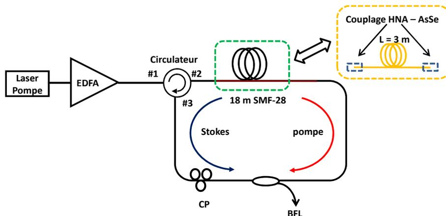
FIGURE 4.22 – BFL en anneau avec pompe résonante dans la cavité
