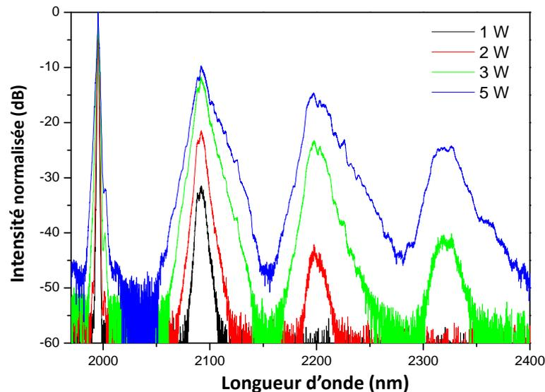
FIGURE 2.19 – Observation de l'effet Raman dans une fibre AsSe MOF.
