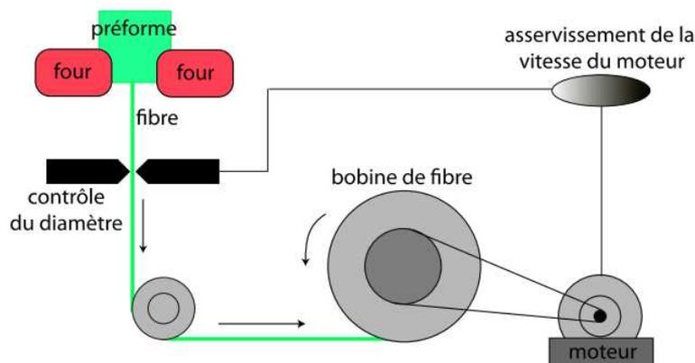
FIGURE 2.1 – Méthode d'étirage d'une fibre optique.
