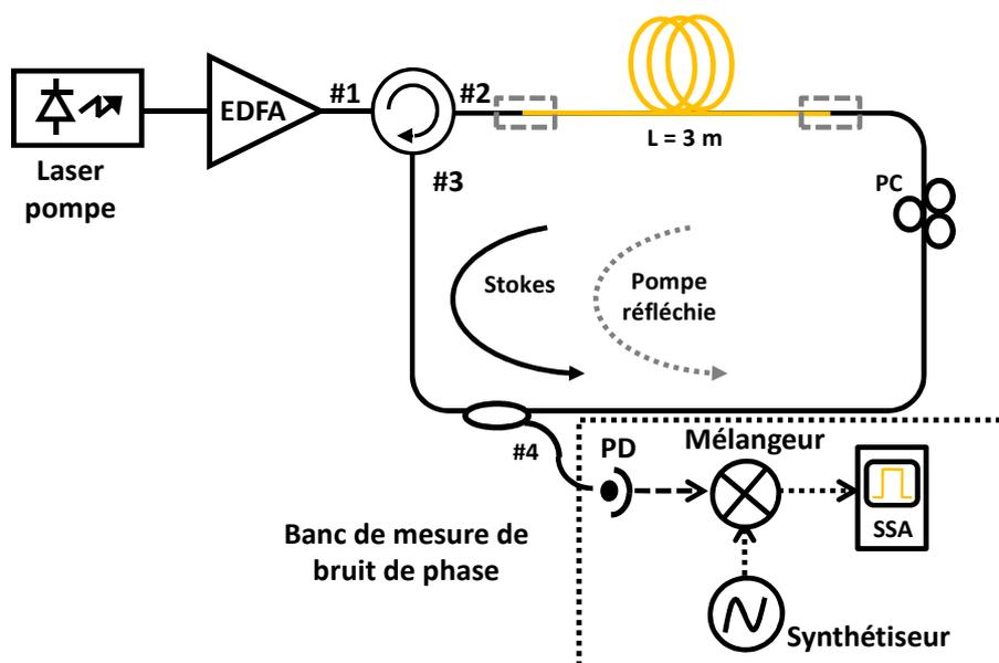
FIGURE 5.6 – Génération d'un signal optique RF à partir du BFL.
