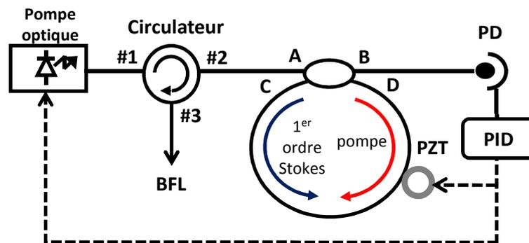
FIGURE 4.2 – BFL en anneau avec pompe résonante dans la cavité.
