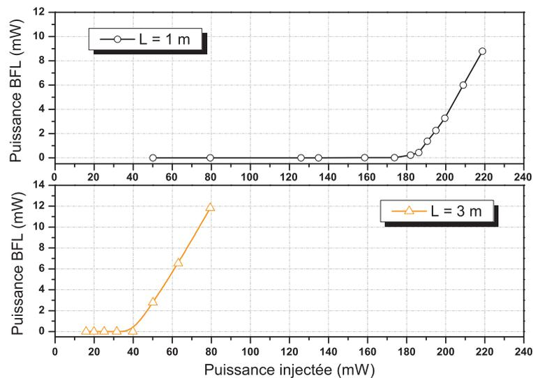
FIGURE 4.6 – Seuil du BFL AsSe en cavité Fabry-Perot
