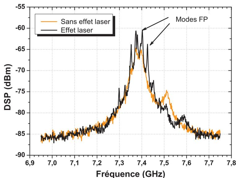
FIGURE 4.4 – Spectre de la bande de gain Brillouin au-delà du seuil Brillouin de la fibre. Nous remarquons la présence de plusieurs pics sur la bande de gain Brillouin; ce qui traduit la présence de modes laser dans la cavité.
