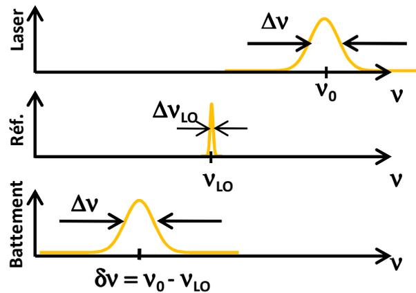
FIGURE 1.23 – Battement hétérodyne de deux lasers.
