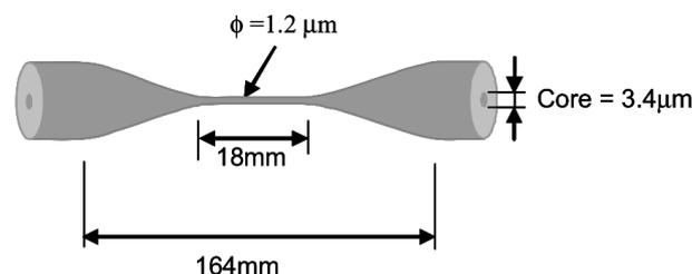
FIGURE 2.6 – Tapers avec un  $\gamma$  de  $68\,000 W^{-1}.km^{-1}$  selon MÄGI.
