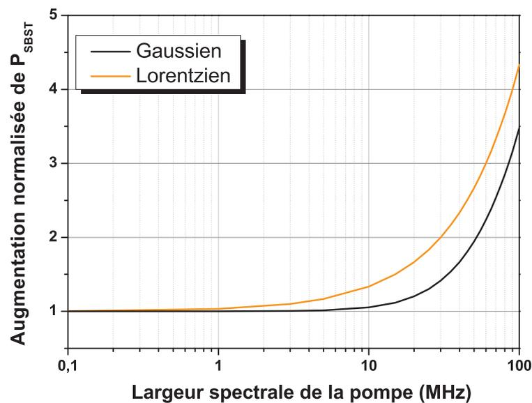
FIGURE 3.10 – Seuil Brillouin  $P_{SBST}$  en fonction de la largeur spectrale de la pompe.
