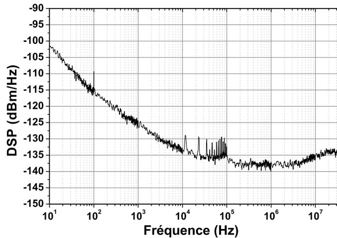
FIGURE 1.19 – Bruit thermique de la chaîne de détection.
