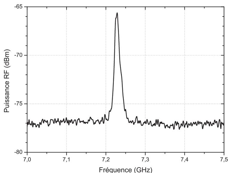
FIGURE 5.5 – Spectre RF du battement entre les ondes pompe et Stokes
