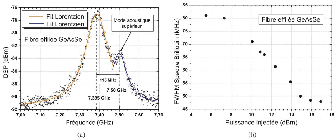
FIGURE 3.26 – (a) Spectre de diffusion Brillouin pour une puissance injectée de  $13,4 \text{ dBm}$  (b) FWHM du pic principal en fonction de la puissance injectée dans une fibre microstructurée GeAsSe de diamètre  $1,6 \mu\text{m}$ . Le fit Lorentzien a été réalisé sur l'ensemble du spectre dû au mode fondamental acoustique. Les valeurs FWHM du spectre Brillouin mesurées prennent donc en considération les deux modes de biréfringence de la fibre.
