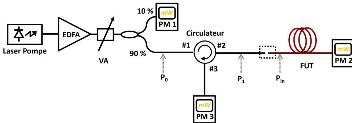
FIGURE 3.11 – Banc de mesure du seuil de la diffusion Brillouin stimulée dans une fibre.
