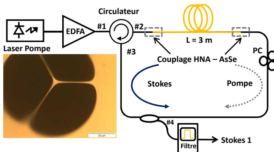
FIGURE 4.7 – Banc expérimental de la cavité BFL avec pompage non-résonant.
