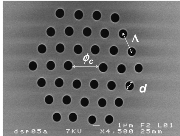
FIGURE 2.2 – Paramètres géométriques d’une fibre optique microstructurée à trois couronnes de trous.  $\phi_c$  : diamètre de cœur de la fibre;  $d$  : diamètre des trous d’air;  $\Lambda$  : distance inter-trous plus connue sous le nom de pitch.
