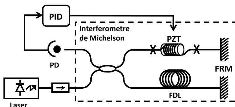
FIGURE 1.27 – Banc de mesure de bruit de fréquence avec un interféromètre de Michelson.
