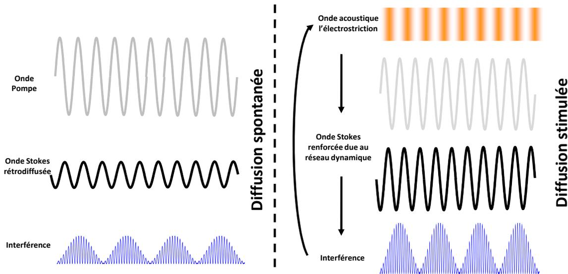
FIGURE 3.4 – Représentation schématique de la SBS.
