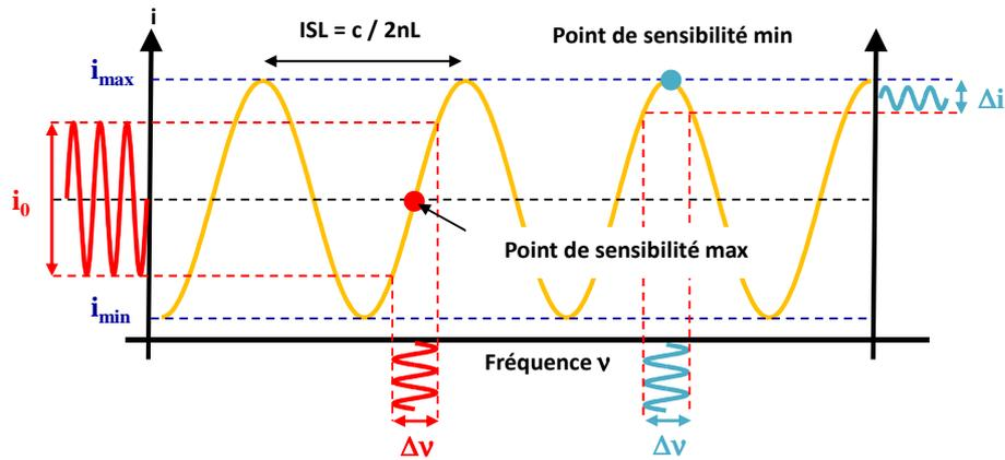
FIGURE 1.28 – Réponse en intensité en sortie du MI à une variation de fréquence d’un laser. Afin d’avoir le maximum de dynamique de conversion en sortie de MI, il est préférable de se placer à 50 % de la valeur maximale (rouge) plutôt que de se placer au point de sensibilité minimum (bleu).
