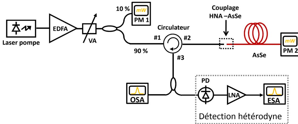
FIGURE 3.17 – Banc de caractérisation du spectre Brillouin simplifié utilisé pour le cas des fibres en verre de chalcogénure.
