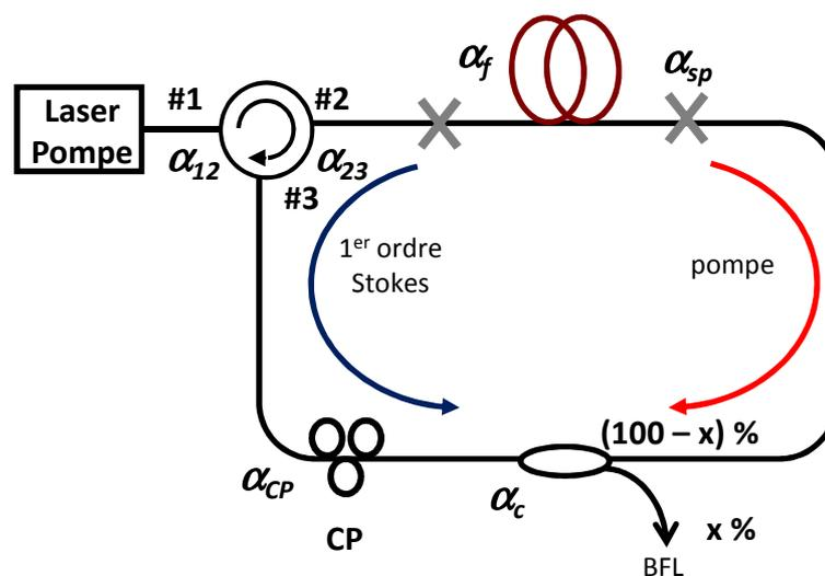
FIGURE 4.10 – Représentation des pertes dans la cavité BFL.
