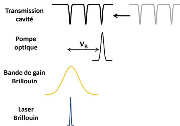
FIGURE 5.10 – Conditions nécessaires pour avoir un laser Brillouin.
