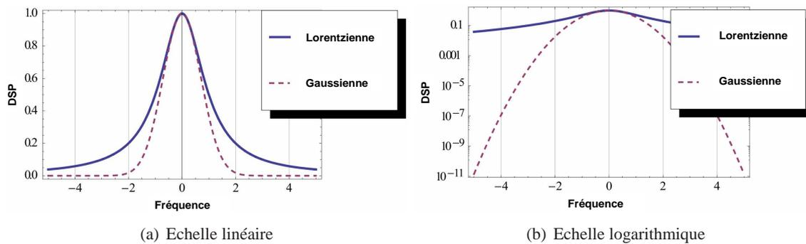
FIGURE 1.17 – Comparaison Lorentzienne/Gaussienne.
