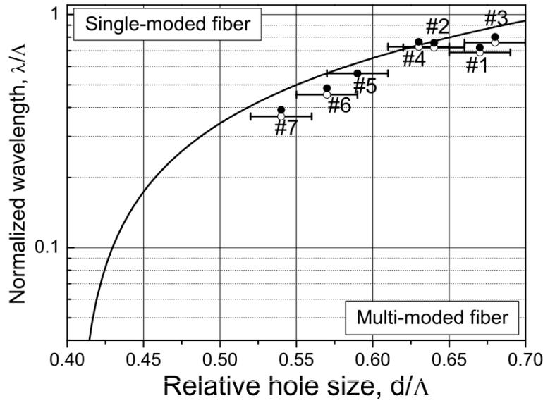
FIGURE 2.3 – Fréquence de coupure relative en fonction du rapport  $d/\Lambda$  selon FOLKENBERG.
