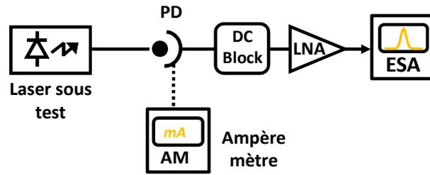
FIGURE 1.18 – Banc de mesure de bruit d’intensité.
