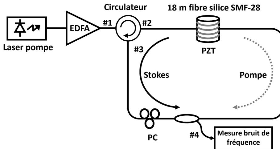
FIGURE 5.3 – Utilisation d'un laser Brillouin en tant que capteur localisé.
