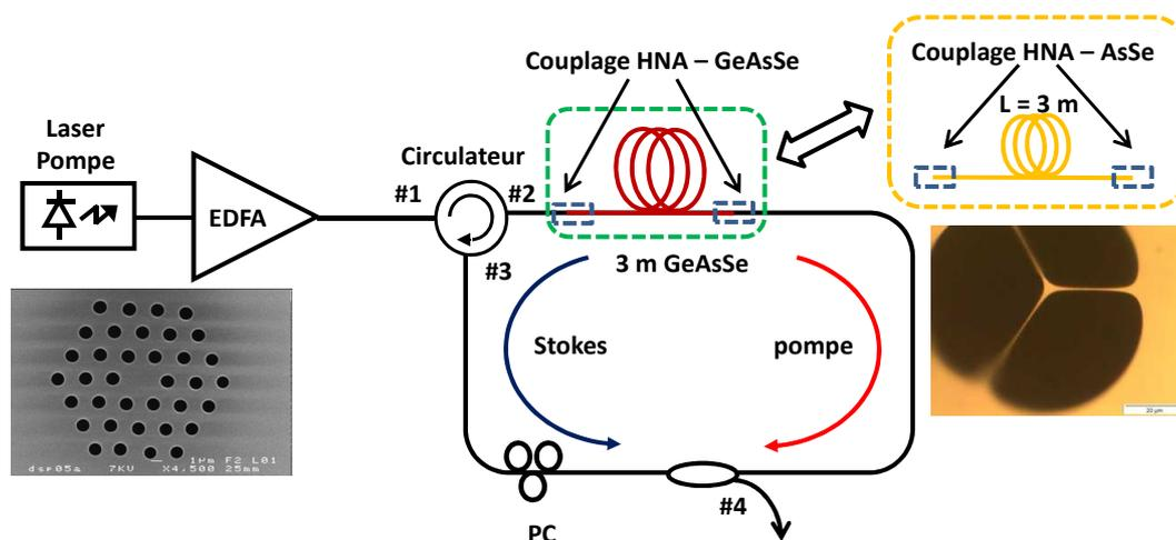
FIGURE 4.26 – Cavité Brillouin réalisée avec une fibre microstructurée GeAsSe (gauche) au lieu de la fibre à cœur suspendu AsSe (droite).
