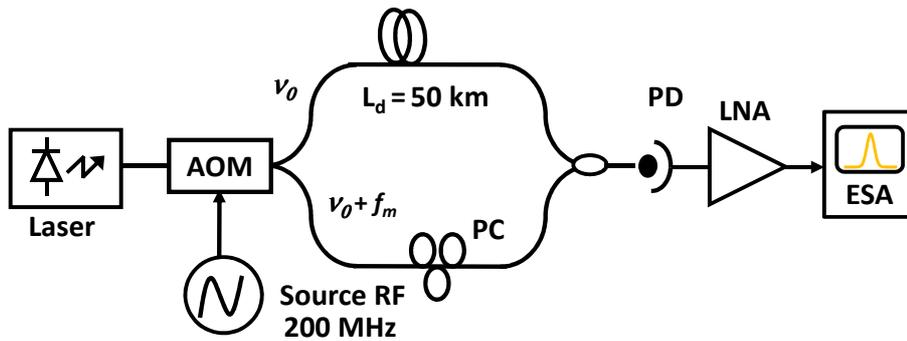
FIGURE 1.24 – Banc de mesure de la largeur de raie utilisant une méthode auto-hétérodyne décorrélée.
