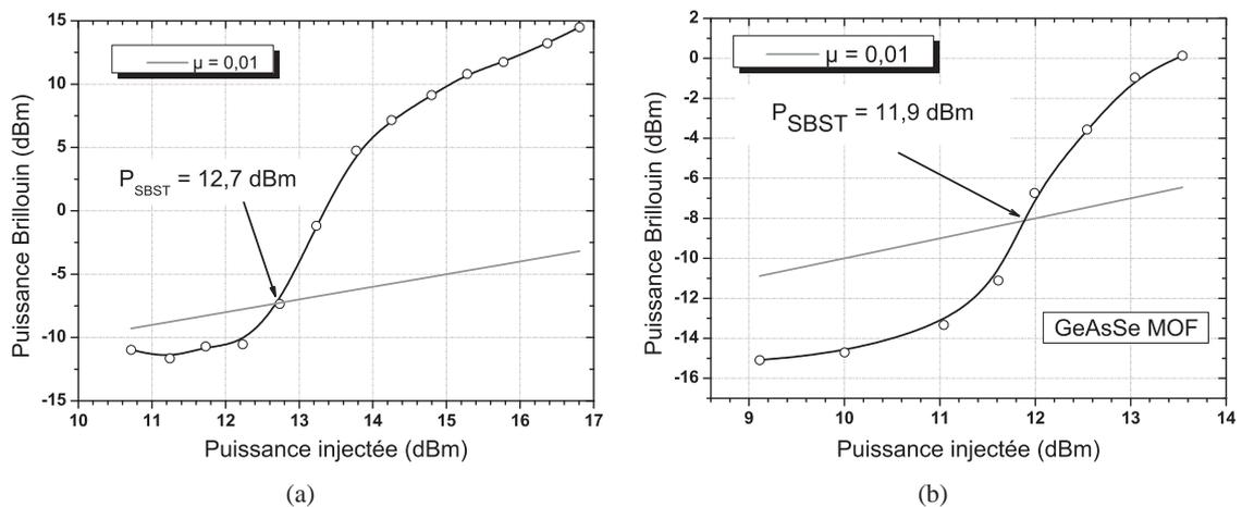
FIGURE 3.23 – Seuil Brillouin de deux fibres microstructurées de 3 mètres en verre de chalcogénure de composition (a) AsSe (4  $\mu\text{m}$  de diamètre) et (b) GeAsSe (3,8  $\mu\text{m}$  de diamètre).
