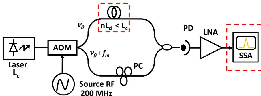
FIGURE 1.30 – Banc de mesure de bruit de fréquence par méthode auto-hétérodyne corrélée.
