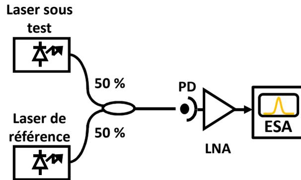
FIGURE 1.22 – Banc de mesure de la largeur de raie utilisant une méthode hétérodyne.
