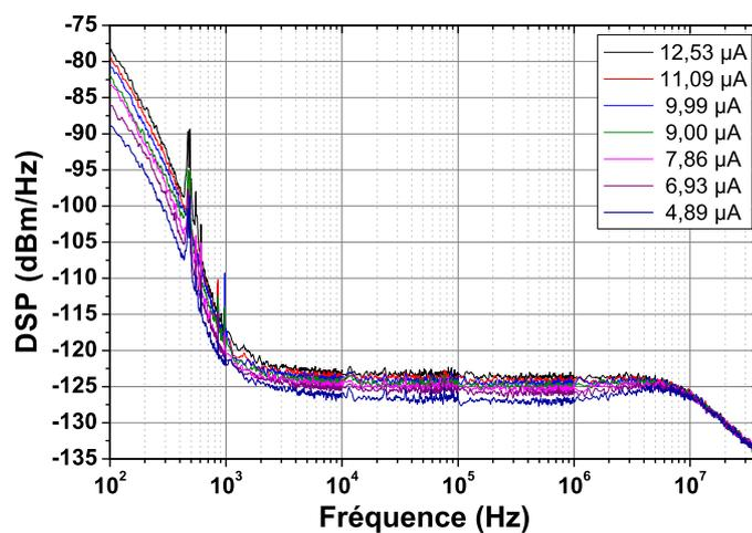
FIGURE 1.20 – DSP mesuré pour différentes valeurs de photocourants.
