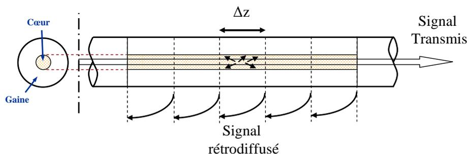
FIGURE B.1 – Illustration de la rétrodiffusion Rayleigh.
