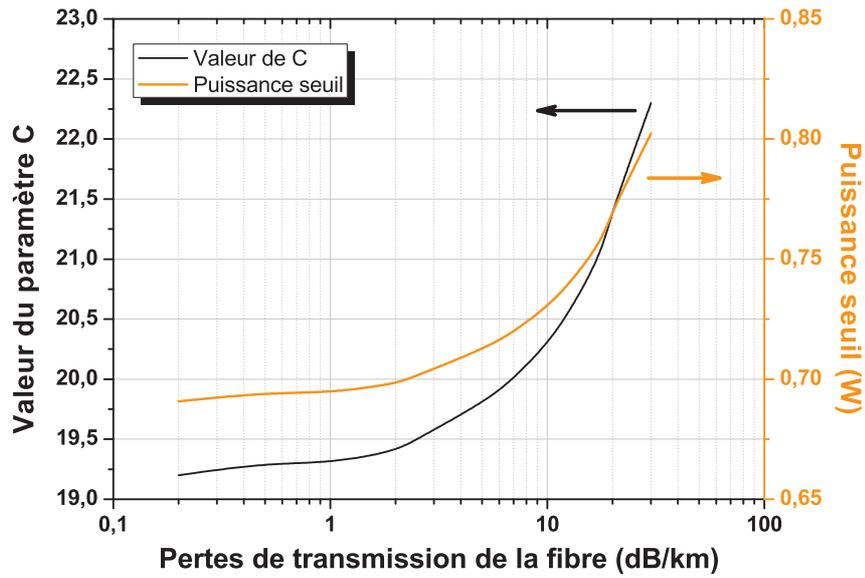
FIGURE 3.9 – Seuil Brillouin  $P_{SBST}$  et paramètre  $C$  pour différentes pertes de transmission de la fibre. La valeur de  $C$  et le seuil Brillouin  $P_{SBST}$  dépendent des pertes de transmission de la fibre.
