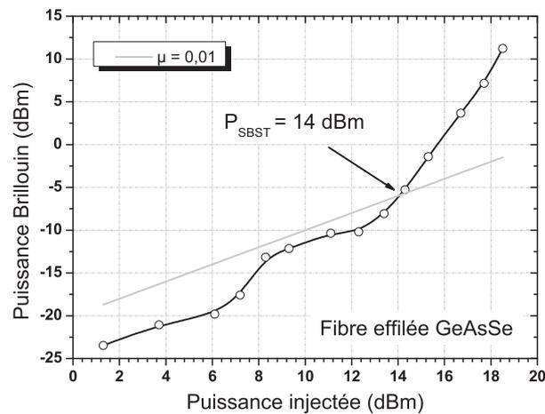
FIGURE 3.27 – Seuil Brillouin de la fibre effilée GeAsSe.
