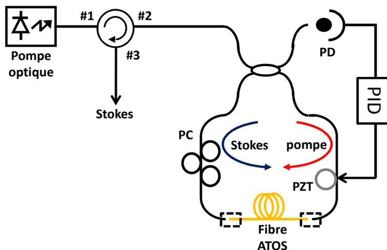
FIGURE 5.8 – Cavité Brillouin avec une pompe résonante envisagée avec l’utilisation fibre ATOS.
