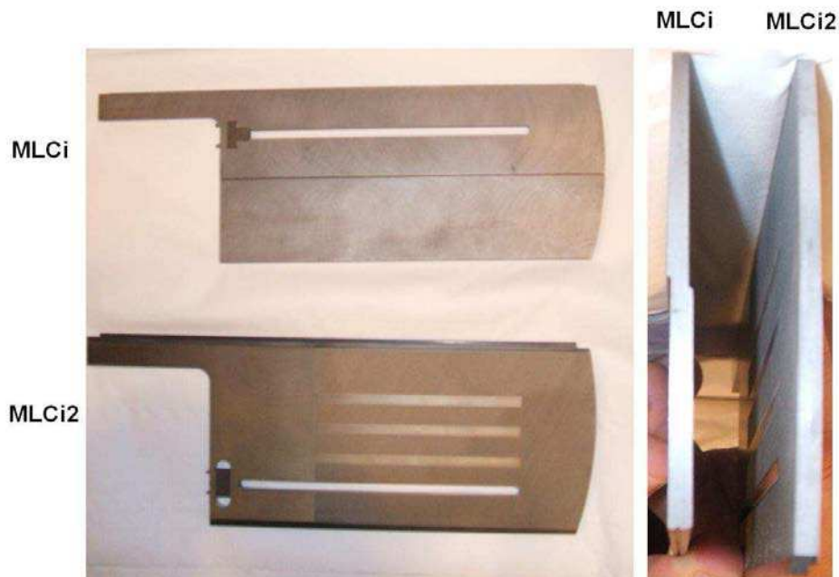
Figure 17 : Photographies de face et de profil de lames issues du MLCi, avec un côté de lame en tenon mortaise et du MLCi2 avec un côté de lame plat.
