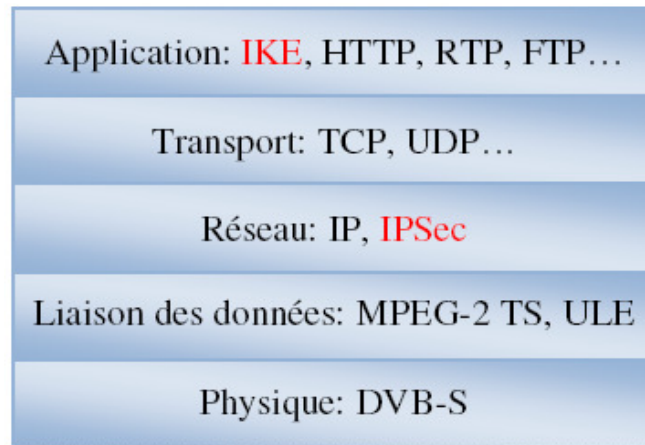
Figure A.1. Modèle TCP/IP pour DVB-S sécurisé avec IPsec
