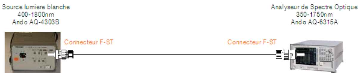
Figure 27 : Configuration expérimentale de référence pour les mesures de perte
