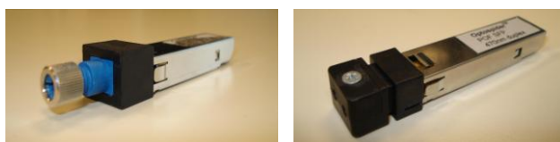
Figure 53 : Des modules SFP 100 Mbit/s mono-fibre de marque Diemount (gauche) et bi-fibre de marque Infineon (droite)
