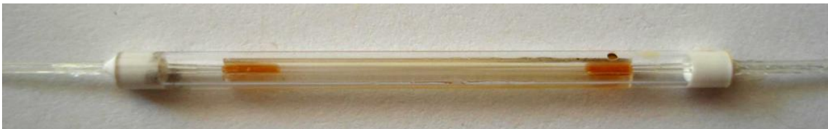
Figure 79 : Photo du coupleur 2×2 à fusion – étirage
