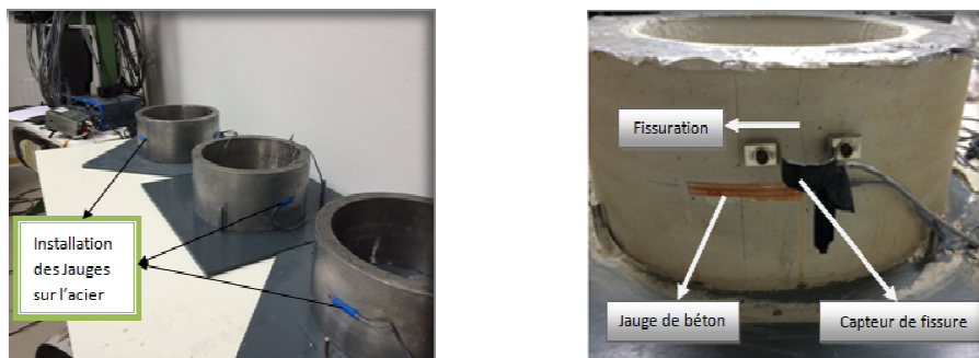
Figure 2. Schéma du dispositif de retrait empêché
