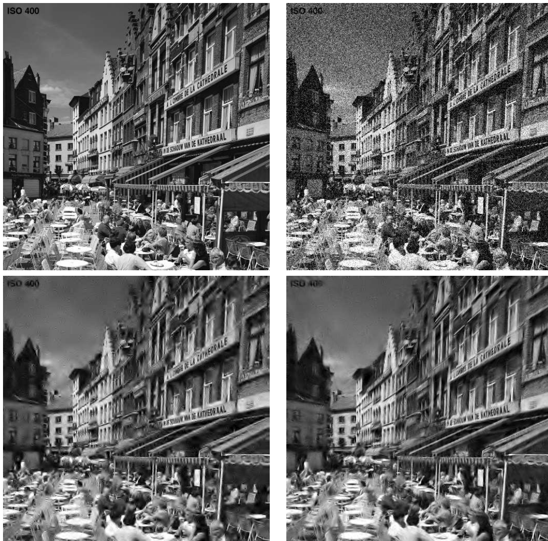
FIG. 4.26: Débruitage de l'image café . [haut gauche] Image originale, [haut droit] image bruitée par un bruit blanc additif gaussien d'écart type \sigma_N = 40 (PSNR = 16.75 dB), [bas gauche] image reconstruite après débruitage par ondelettes séparables (PSNR = 21.03 dB), [bas droit] image reconstruite après débruitage par ondelettes orientées (PSNR = 21.47 dB).
