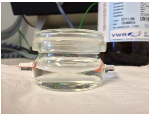
Figure 113 : Photo de la cellule hermétique permettant le maintien de la fibre en contact avec la solution à détecter
