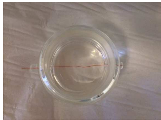
Figure 113 : Photo de la cellule hermétique permettant le maintien de la fibre en contact avec la solution à détecter
