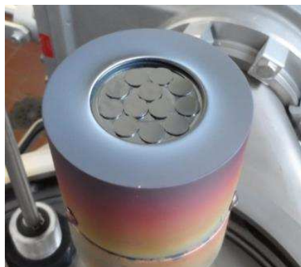
Figure 135: Photo montrant le positionnement des pastilles au niveau de la cathode dans le bâti de pulvérisation.
