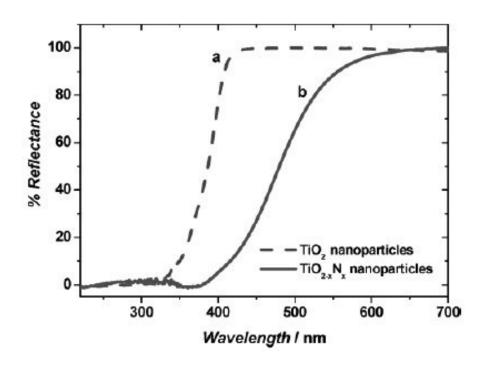
Fig. 1 : Diffuse reflectance spectra of  $TiO_2$  and  $TiO_{2-x}N_x$  oxynitride [1].
