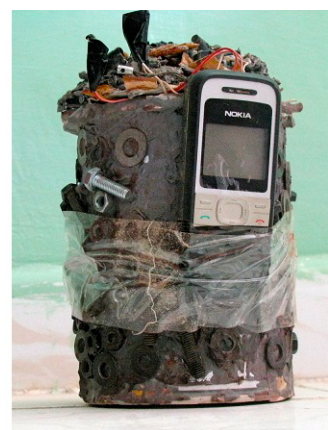
FIGURE 1.4 – Exemple d'EEI déclenché par un signal de téléphonie mobile
