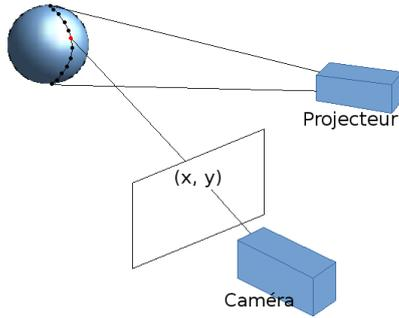
**Figure 2:** Illustration de l'estimation de la position d'un point dans l'espace par projection d'une lumière structurée (ici le motif est une bande). La position du point sera déterminée par l'intersection entre la droite partant de la caméra et le plan de la bande de lumière projetée.
