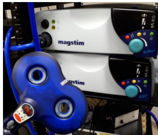
Figure 7. Stimulateur électromagnétique Mag Stim 200 et bobine de stimulation en forme de 8
