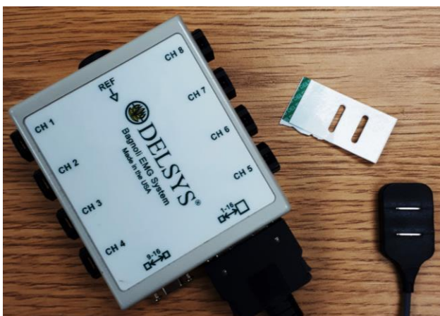
Figure 8. Électrode d'EMG de surface, collant double-face et unité préamplificatrice
