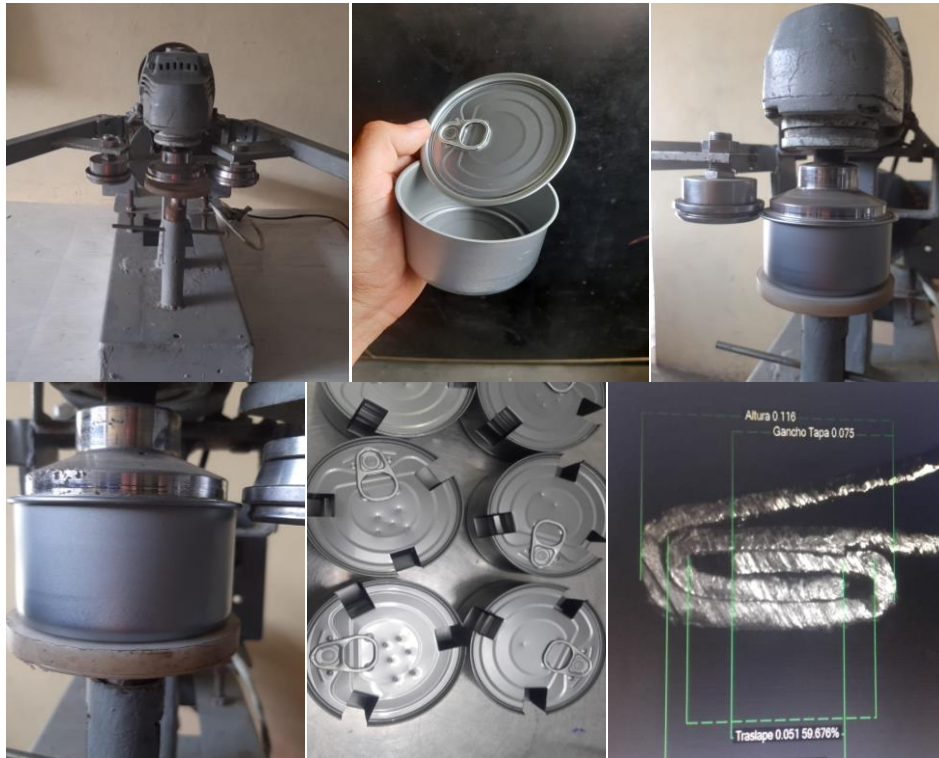
Figura 7. Banco de pruebas desarrollado y proceso de cierre.
