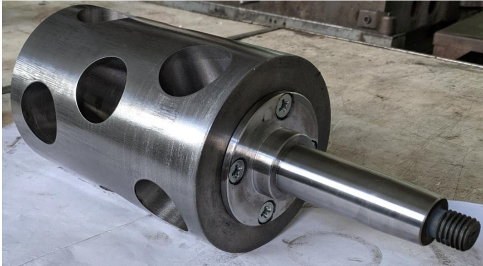
Рисунок 3.3 – Центральний ротор з отворами під поршні
