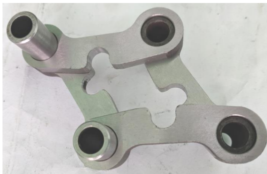
Рисунок 3.5 – Ланки шарнірного чотирикутника
