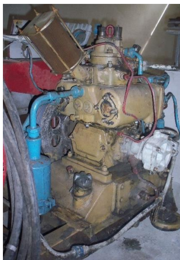
Рисунок 3.13 – Компресор високого тиску K2-150
