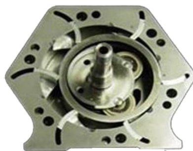
Рисунок 1.24 – Роторний повітряний двигун розробки Анжело ді П'єтро
