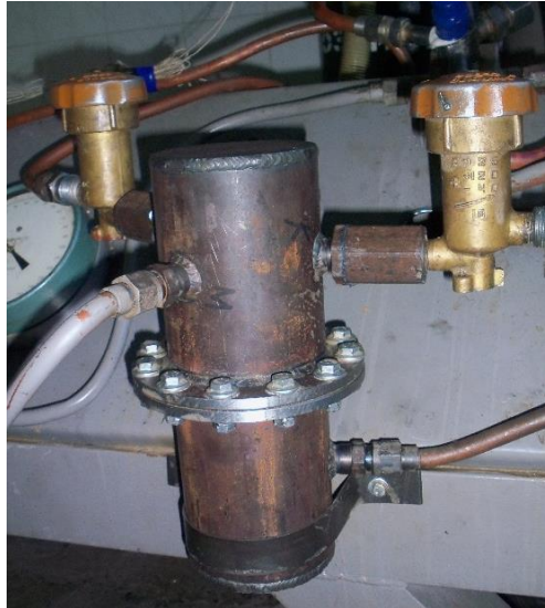
Рисунок 3.11 – Повітряний ресивер розподілу низького тиску із запірними кранами
