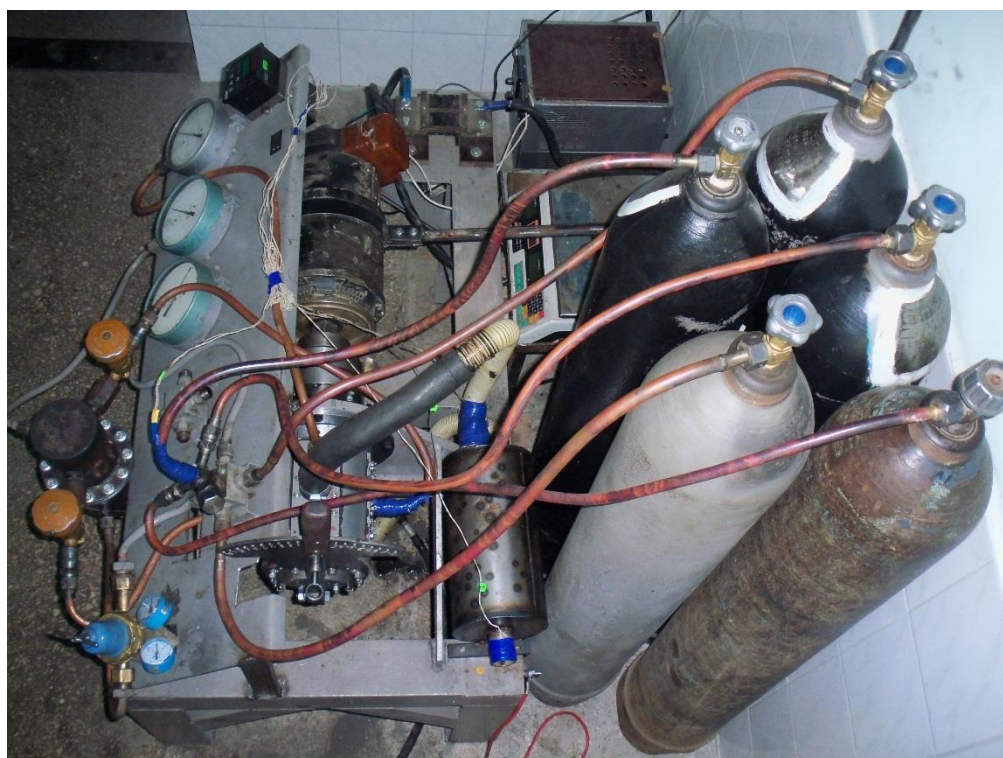
Рисунок 3.9 – Загальний вигляд експериментального станда та панелі приладів на базі роторно-поршневого двигуна 12РПД 4,4/1,75
