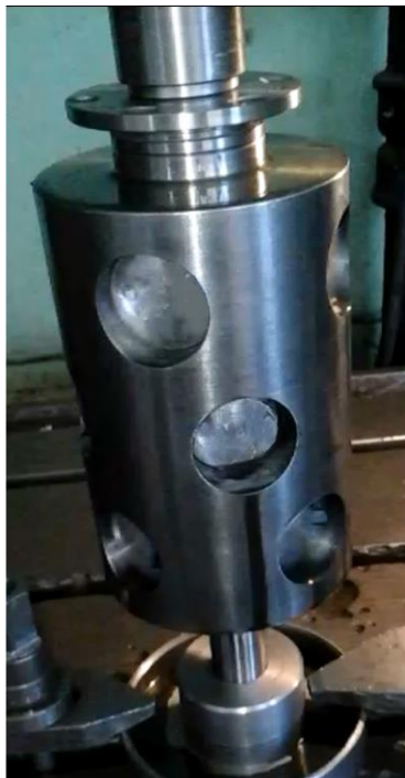
Рисунок 6.17 – Притирання механізму руху та циліндрів з поршнями роторно-поршневого двигуна
