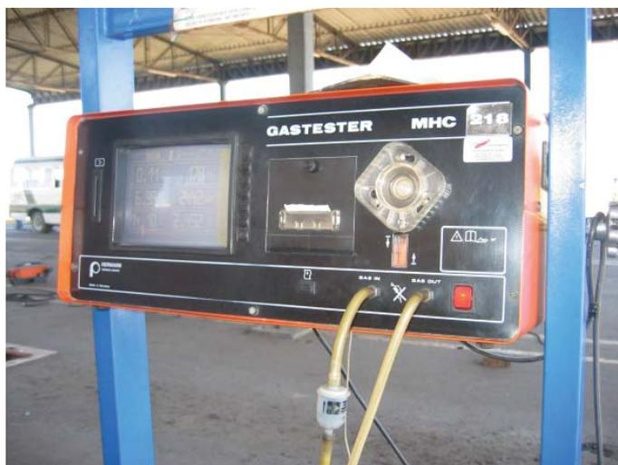
Equipo de medición de emisiones vehiculares de la planta de control de emisiones de Arequipa.
