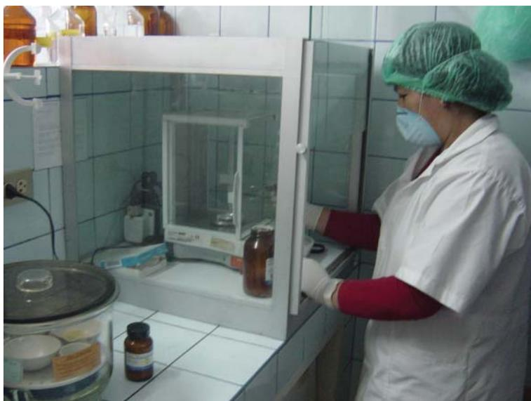
Balanza de precisión para pesar filtros en el monitoreo de  $\text{PM}_{10}$ .
