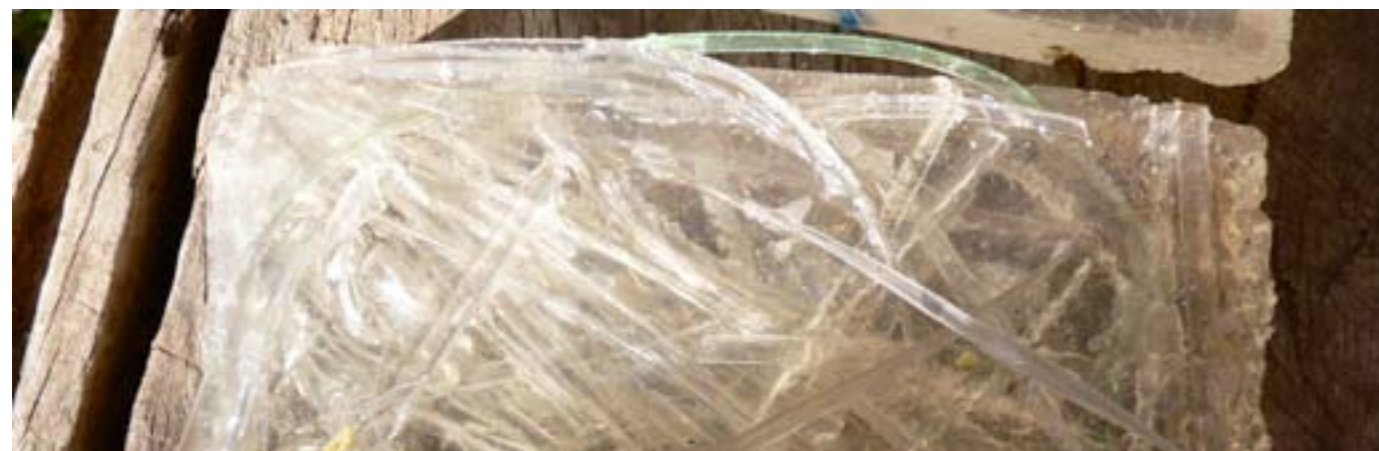
P2 HILOS DE PET + RESINA POLIÉSTER
