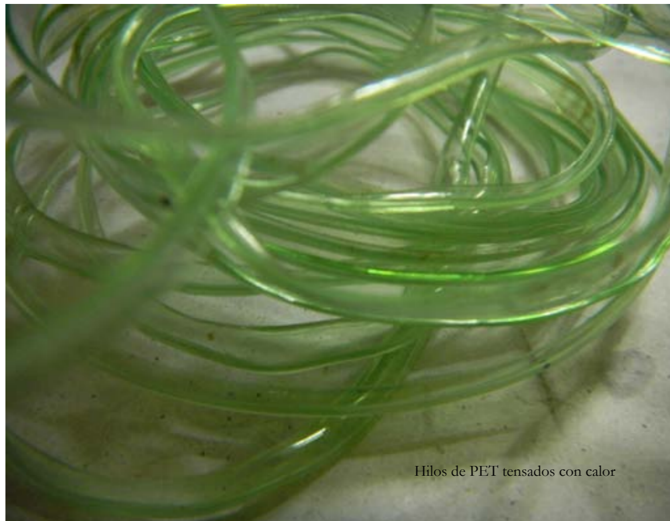
Escamas de PET sometidas a fuente de calor
