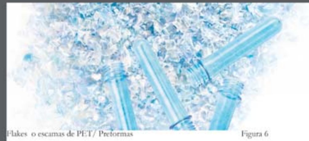
Flakes o escamas de PET utilizada para extrusion o inyeccion
