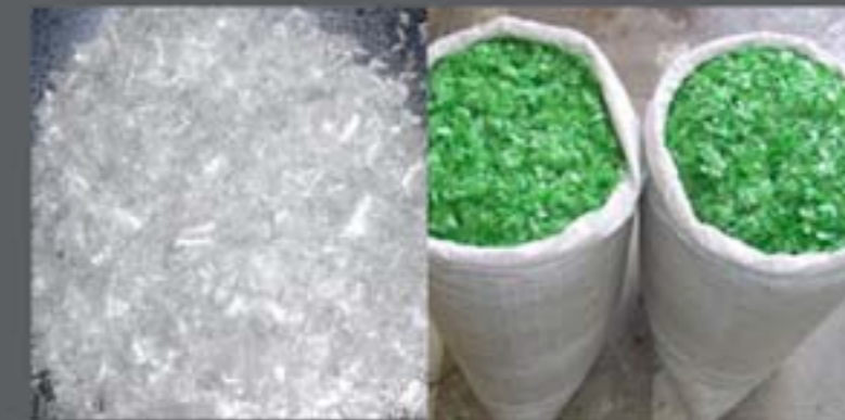
Flakes o escamas de PET utilizada para extrusion o inyeccion
