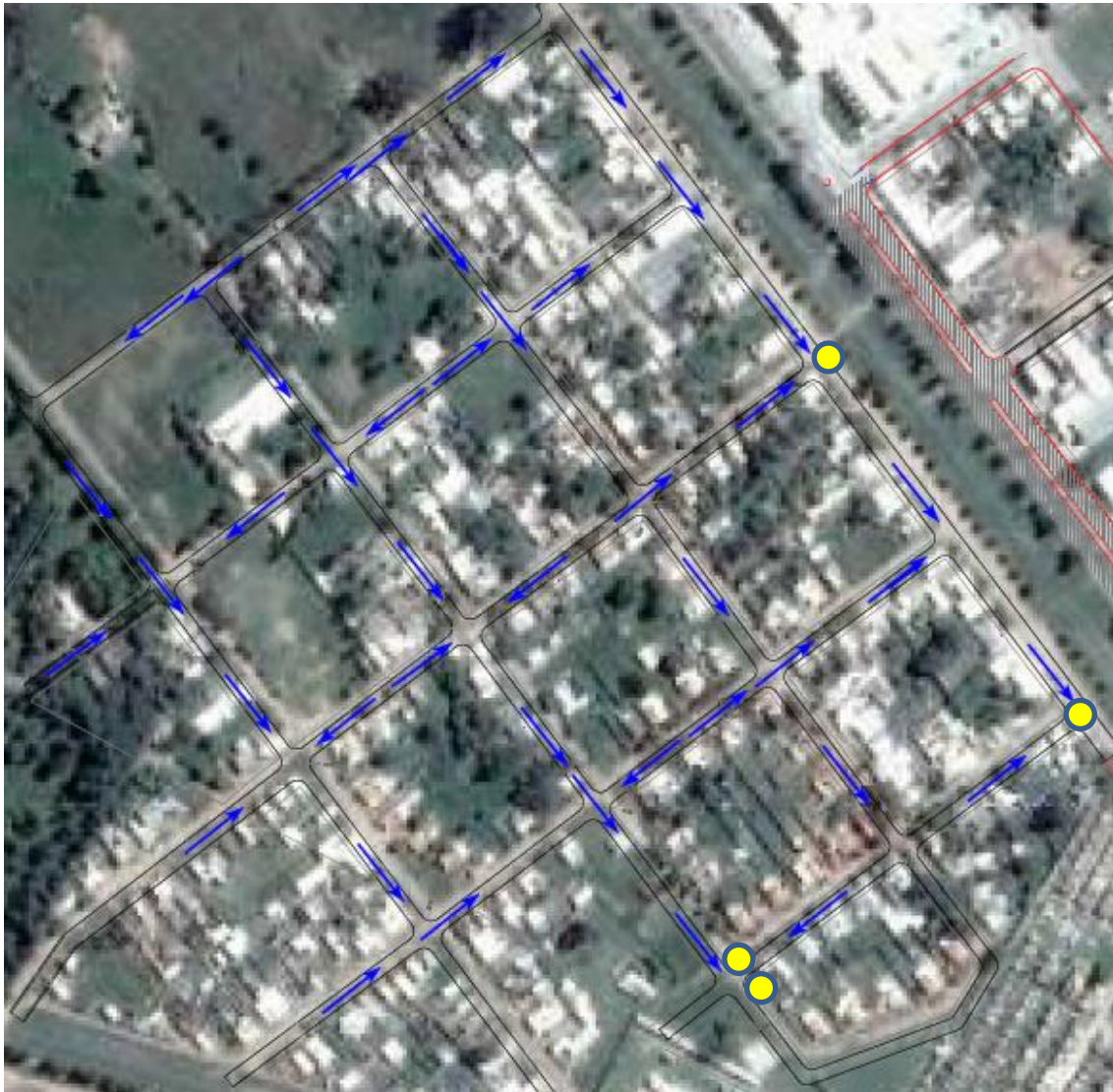
Figura 4-2 - Vista general de proyecto de cordón cuneta del barrio. En amarillo la ubicación de las bocas de tormenta proyectadas.
