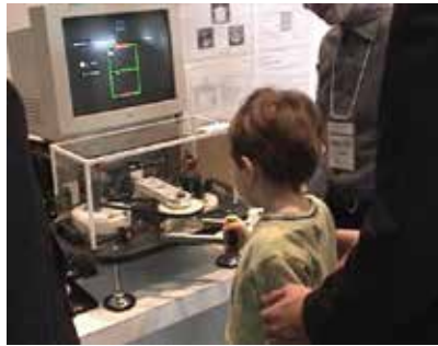
Fig. 2. Passive force display using ER brakes [14]
