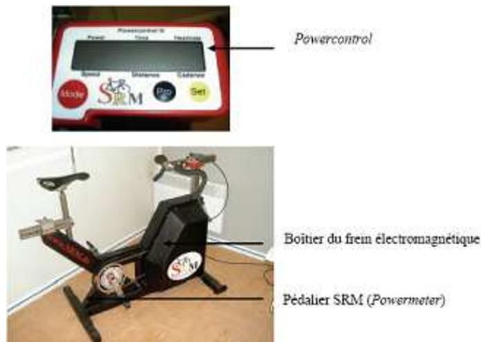
Figure 30 : ergocycle (photo extraite d'un rapport de recherche de l'INSEP<sup>647</sup>).
