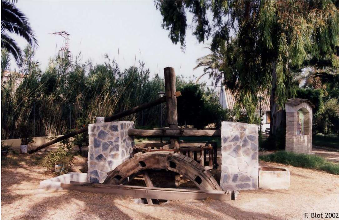
Figure 11 – Système de pompage mu par traction animale. Murcie
