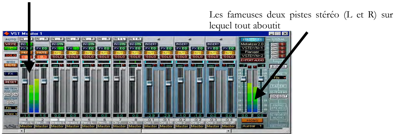
Figure 10 la page dédiée au mixage dans le même logiciel est également la réplique d’une console “en dur”.
