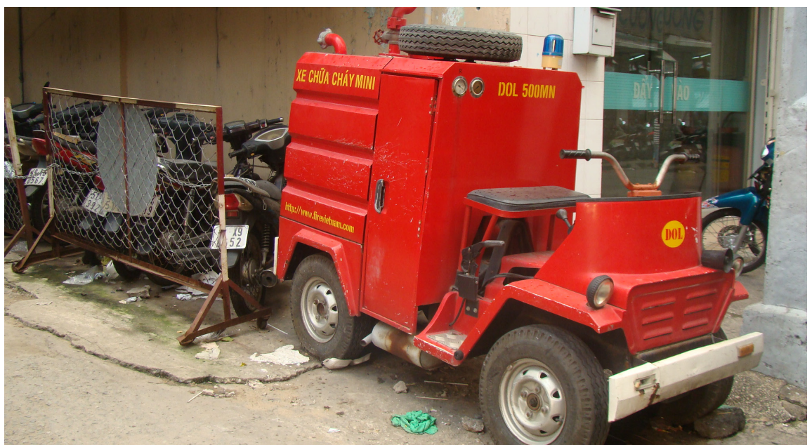
Hình 6. Một ví dụ xe chữa cháy đặc chế phù hợp với địa hình đường hẻm
