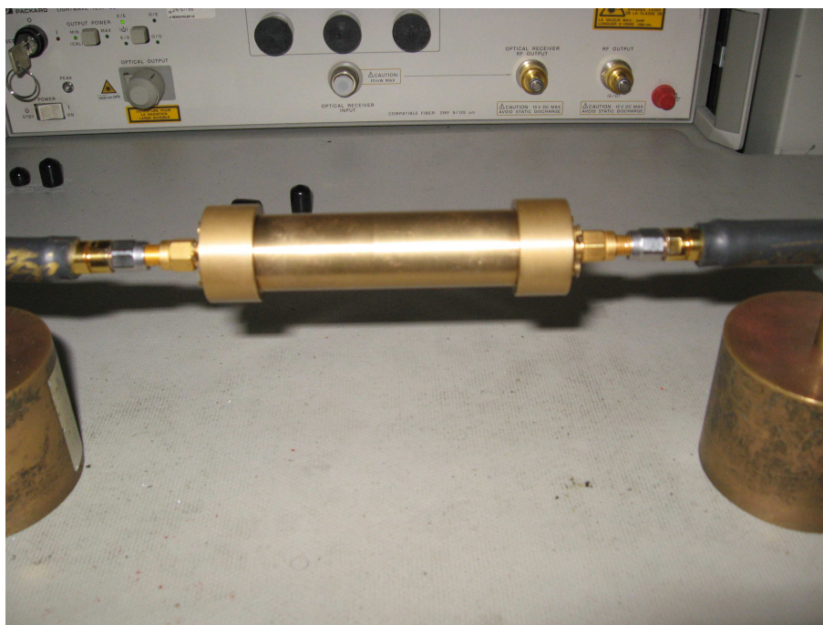
Figure 11: Monture coaxiale circulaire en laiton, de longueur L=50\text{mm} , D = 14,36\text{mm} et d = 4\text{mm} montée sur l'analyseur de mesure (VNA 8510C)
