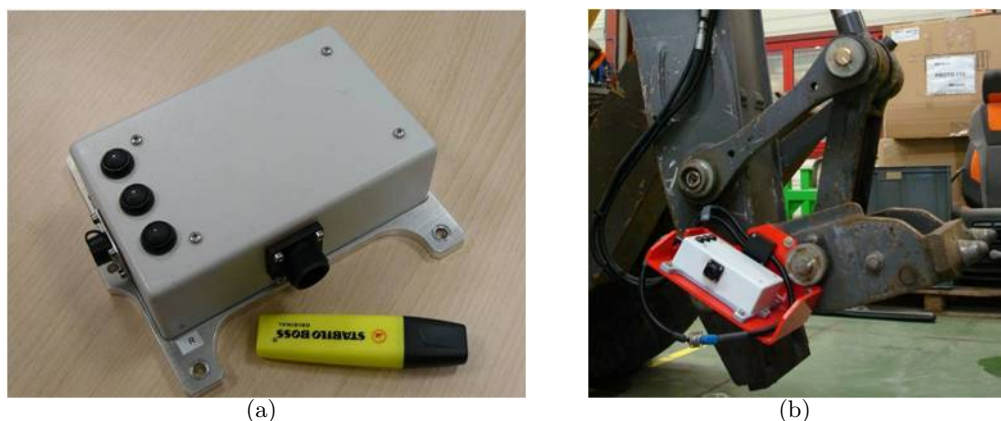
Figure 4.10 – Montage du capteur d'horizontalité sur le porte-outil, a : Capteur, b : Montage sur le porte-outil
