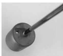
Figure 2-5 : Electrode en carbone vitreux fabriquée à l'aide d'un creuset (Carbone Lorraine) et d'une tige (HTW) collés par la colle Resbond 931C
