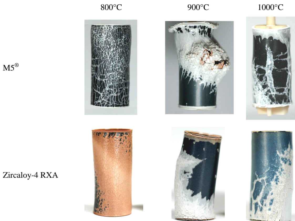
Figure V-2 : Images macroscopiques d'échantillons de gaine de M5 ® et Zy-4 RXA après oxydation sous air à 800°C (ECR = 20%), 900°C (ECR = 28%) et 1000°C (ECR = 37%)
