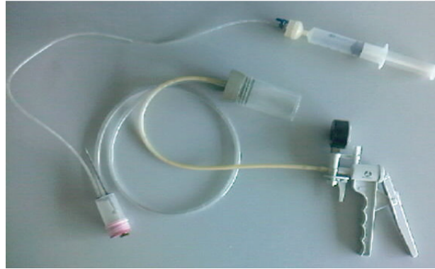
Figure 20: Dispositif de prélèvements des substrats naturels utilisé lors de la campagne de mai 2008 et mis en œuvre également à la station Aquarium.
