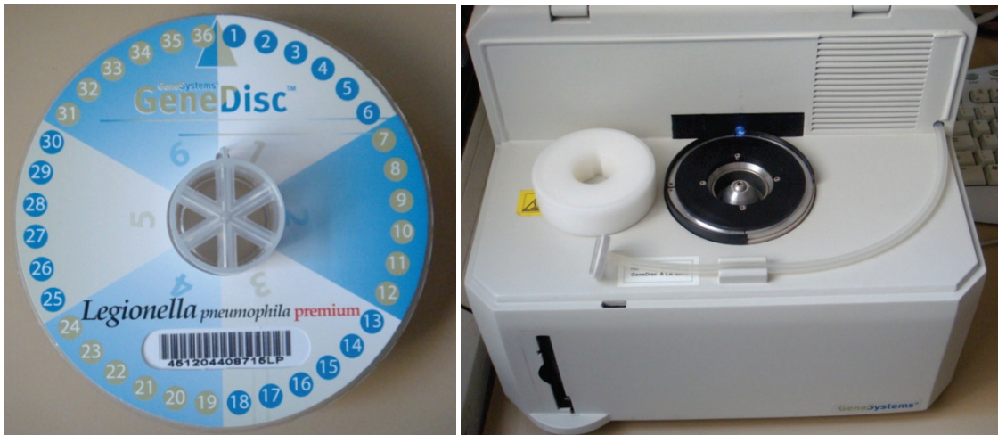
Figure 24: GeneDisc vu de dessus (à gauche) et GeneDisc cycler (à droite).
