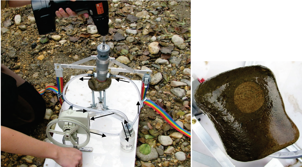
Figure 19: Dispositif d'échantillonnage des substrats naturels (à droite: visualisation du biofilm par différence avec la zone échantillonnée). Les flèches représentent le sens de circulation de l'eau entre le pilulier et la zone du substrat échantillonnée.
