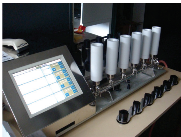
Figure 23 : GeneExtract équipé des cylindres de filtration.
