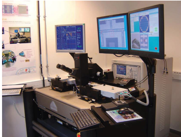
Figure II-24 Photo du banc de mesure des paramètres S à l'IMEP-LAHC [Quemerais, 10].
