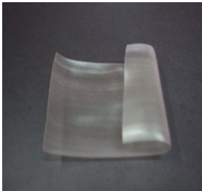
Figura 20. Película obtenida con la extrusora del reómetro de torque del ICIPC para la mezcla 70A18G12A muestra 2
