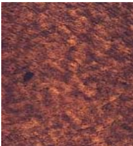
Figura 45. Morfología, visión global, de la mezcla 72A 12G 16A a 50 aumentos (foto 1) y a 100 aumentos (foto 2) realizada en el ICIPC
