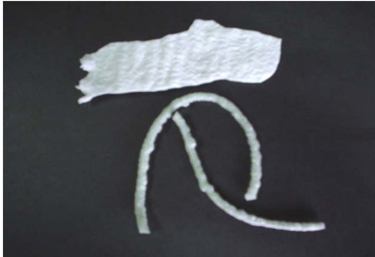
Figura 6. Muestra Procesada en el molino abierto del Instituto y luego extruída en Arcolor
