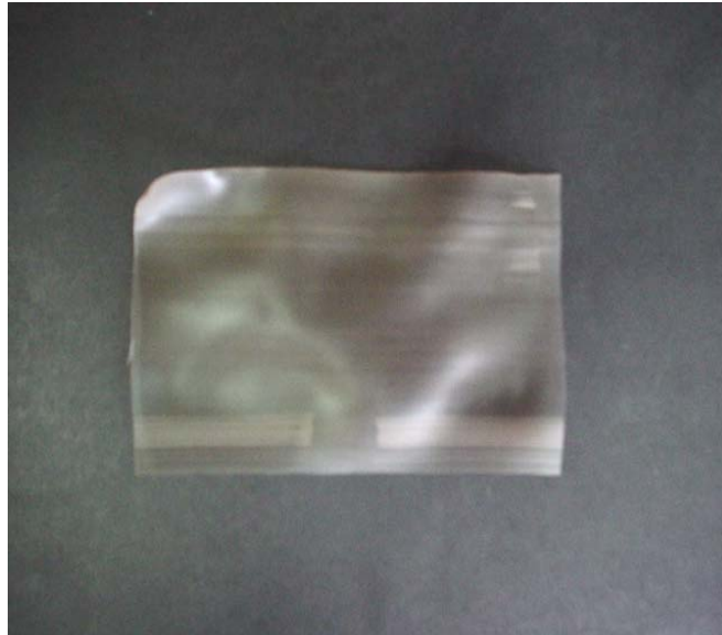
Figura 21. Película obtenida con la extrusora del reómetro de torque del ICIPC con la mezcla 67A24G9A
