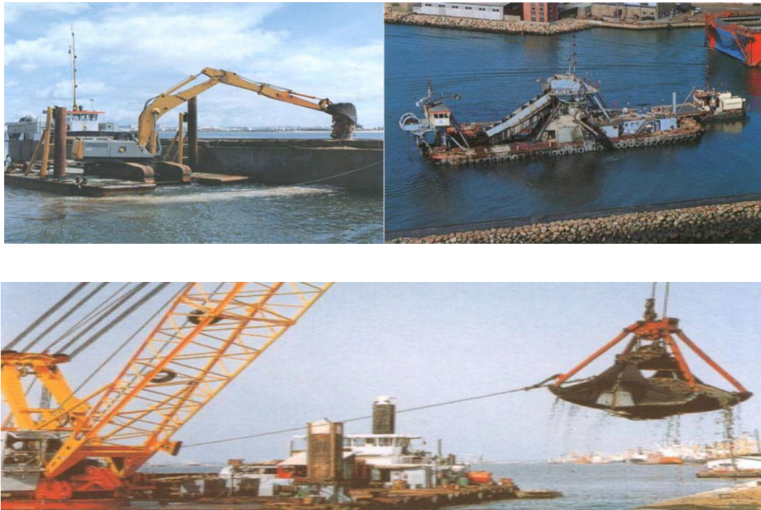
Figura 19 – Dragas Mecânicas, de escavação, de baldes e de maxilas [11]
