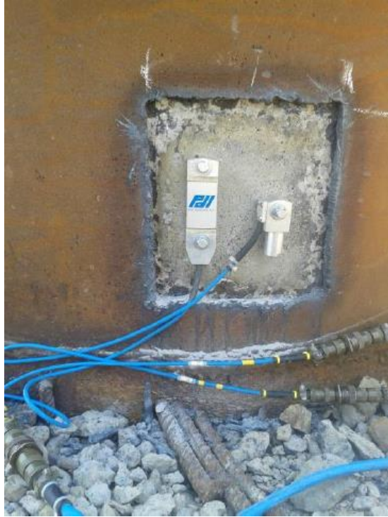
Figura 75 - Par de transdutor de deformação específica e acelerómetro [28]
