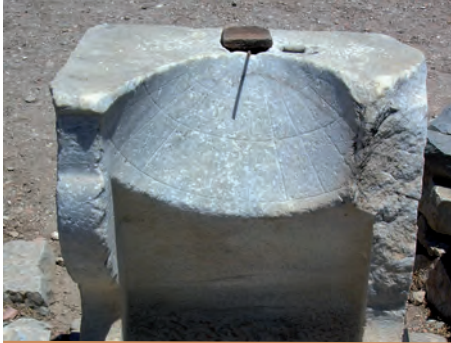
(fig.1) - Cadran solaire conique de Cnide, en Turquie. Onze lignes horaires divisent le cône en douze secteurs et trois courbes de dates sont tracées : solstice d'été (en bas), solstice d'hiver (en haut), équinoxes (au centre). On voit l'ombre d'un gnomon dont l'extrémité indique que la cinquième heure est passée.
