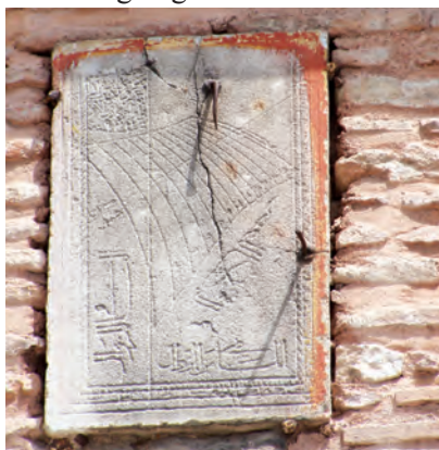
Fig. 2 : Cadran solaire du XVI e siècle gravé sur une pierre et installé à Constantinople sur la basilique Sainte-Sophie transformée en mosquée au XV e siècle. On voit nettement la ligne verticale de midi coupée par une droite inclinée qui indique les équinoxes. Celle-ci est encadrée par deux arcs d'hyperboles qui indiquent les solstices (été en bas, hiver en haut). Les treize arcs qui occupent le cadran indiquent combien de temps il reste avant la prière de l' asr : ils sont tracés toutes les vingt minutes.
