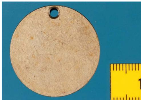
Abbildung 5-2: Foto und Skizze mit Maßen der Scheibenprobe
