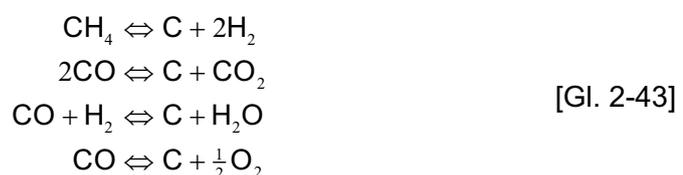
In den Folgereaktionen auf der Oberfläche des Stahls wird schließlich der Kohlenstoff zur Diffusion freigesetzt [Gro89]:
