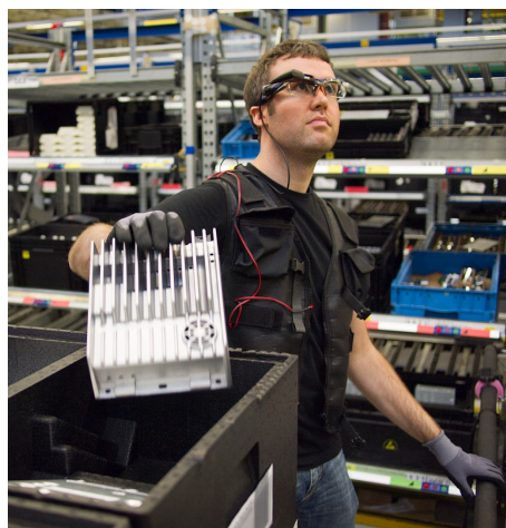
Abbildung 3.15: HMD mit einer optischen Darstellung (Quelle: http://www.technologiepark-bremen.de/de/techpark-news-detail?sv[id]=297109 )
