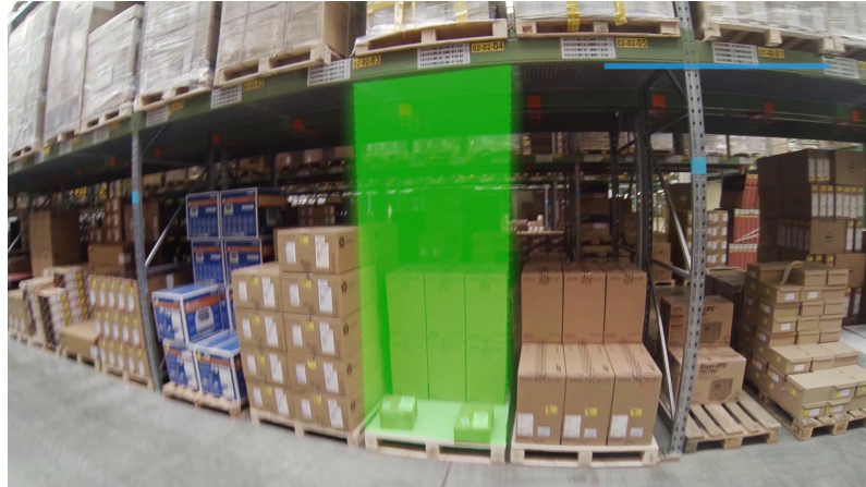
Abbildung 3.12: Beispielhafter Einsatz eines Augmented Reality (AR) Systemes zu Anzeige eines gesuchten Lagerplatzes (Quelle: http://www.salt-solutions.de/blog/index.php/die-neun-vorteile-von-google-glass-der-logistik/ )
