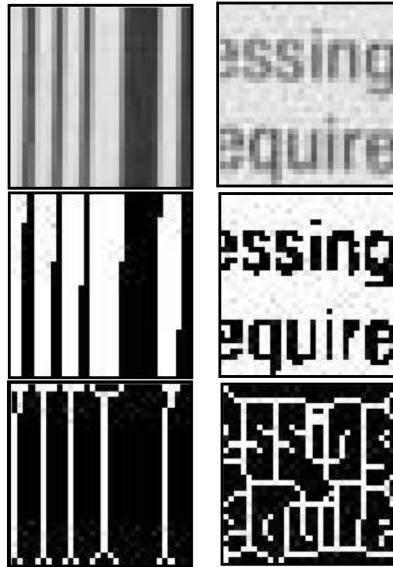
Abbildung 3.41: Ausgeschnittene, in Binärdaten konvertierte und skelettierte Blöcke (Quelle: [14])
