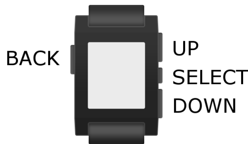
Abbildung 6.21: Steuerung der Pebble über vier Buttons
