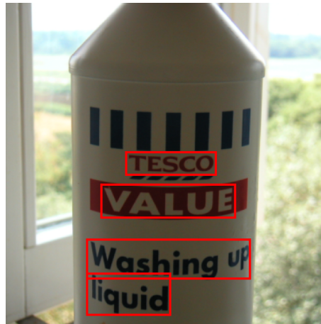
Abbildung 3.37: Erfolgreiche Textdetektion und Lokalisierung in einem digitalen Bild (Quelle: [37])
