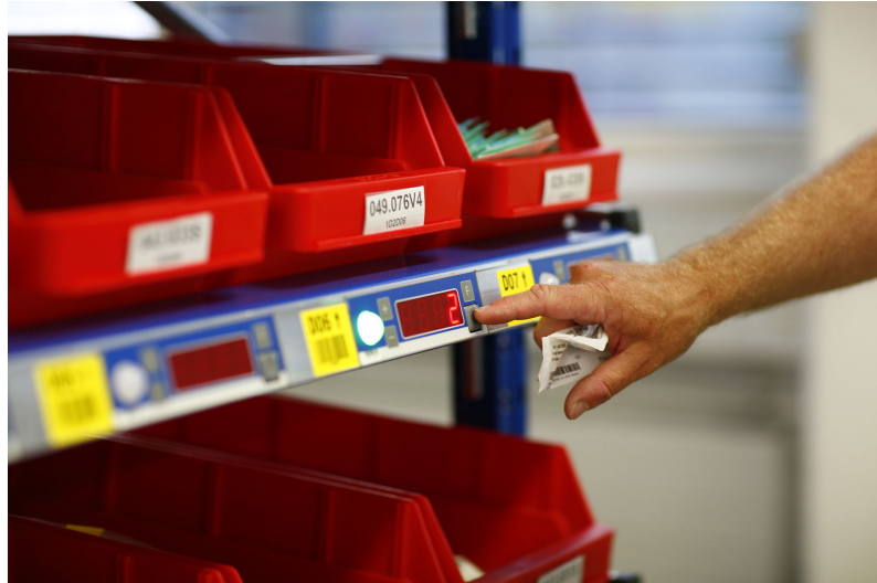
Abbildung 3.8: Pick-by-light Einheit, welche eine Entnahmestelle markieren und die zu entnehmende Menge Anzeigen kann (Quelle: http://commons.wikimedia.org/wiki/File:Pick-by-Light-Fachanzeigen_PickTermFlexible.JPG )
