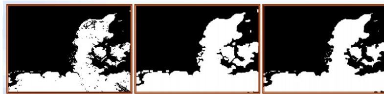
Abbildung 3.20: Closing: zunächst Dilatation dann Erosion (Quelle: http://kurse.fh-regensburg.de/cato/module/bildverarbeitung/bv/5_4filter/5_4filter.pdf )
