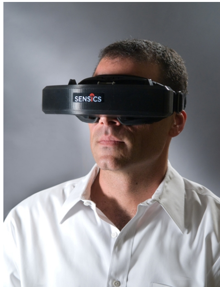
Abbildung 3.14: Head-Mounted-Display (HMD) mit einer Videodarstellung (Quelle: http://sensics.com/news-events/press-kit-and-product-photos/ )
