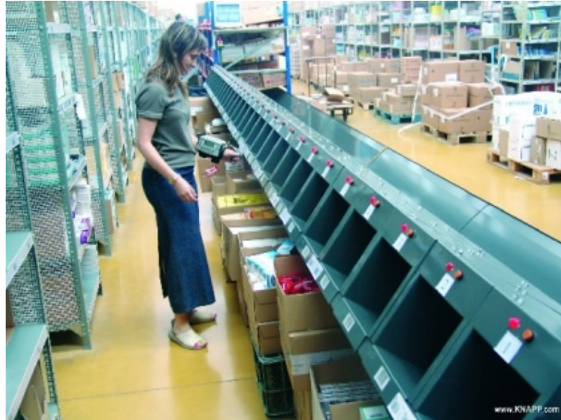
Abbildung 3.9: Put-to-light-System, bei dem die Aufträge in Schächte mit Lämpchen kommissioniert werden (Quelle: http://www.fml.mw.tum.de/fml/index.php?Set_ID=320&letter=P&b_id=3946337B-4431-4430-382D-463133412D34 )
