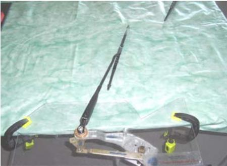
Struktur des Phänomens gewonnen werden können. Durch das Betätigen der Kurbel des Einarmscheibenwischers wird im Experiment die Wischfläche sichtbar, anhand derer man Vermutungen über die geometrischen Formen der Wischfeldbegrenzung und somit zur gewischten Fläche treffen kann. Mithilfe eines Tafelzirkels erkennen die Schülerinnen
