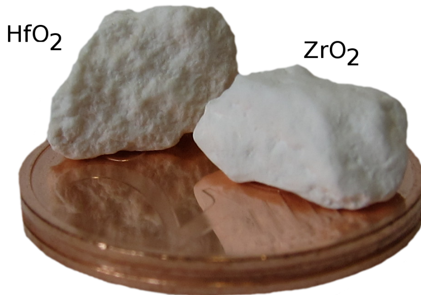
Abbildung 4.1: Verdampfermaterial aus gesintertem Hafnium- und Zirkoniumdioxid.
