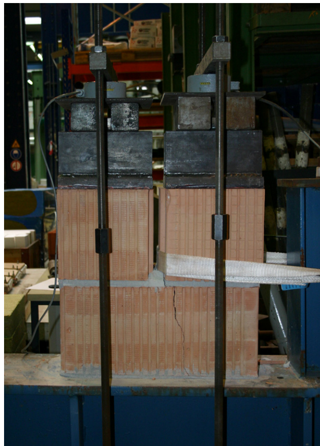
Bild 8.18 Rissbild Versuch Steinrandzugfestigkeit
