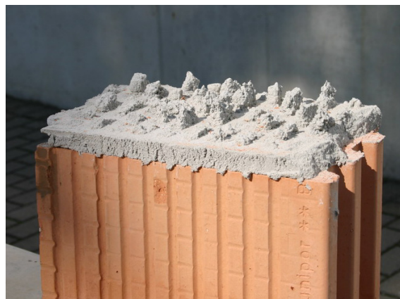
Bild 8.6 Verzahnung des Mörtels bei Hochlochziegel
