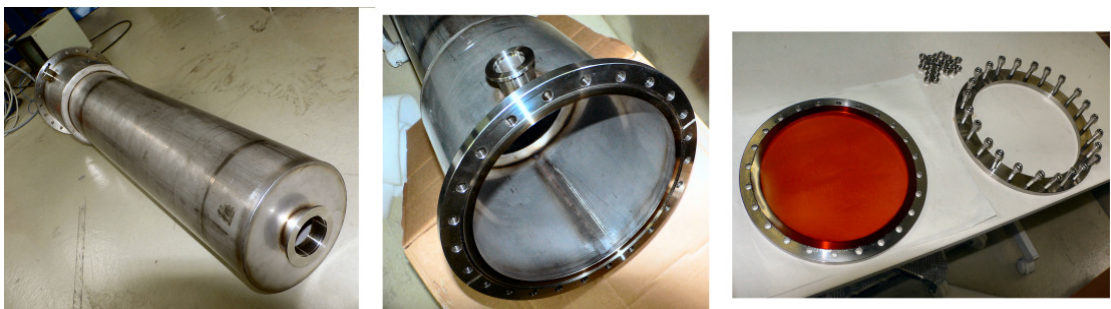
Abbildung A.4: Links+Mitte: Vakuum-Rohr. Rechts: Auf Trägerring aufgeklebtes Kaptonfenster, das mittels einer CF-200 Kupferdichtung und des Andruckrings mit dem Vakuumrohr verbunden wird.
