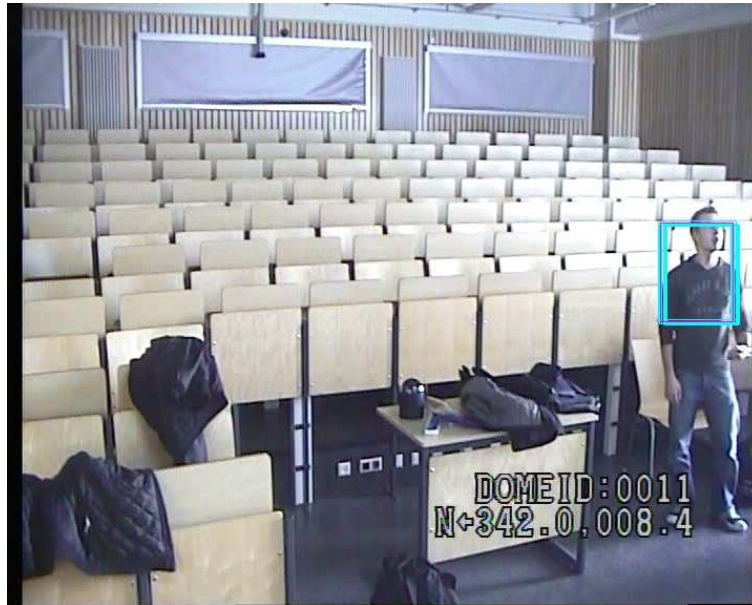
Abbildung 67: Die Abbildung zeigt die gestreuten Partikel in Rechteckform, dabei ist das blaue das höchst gewichtete Rechteck
