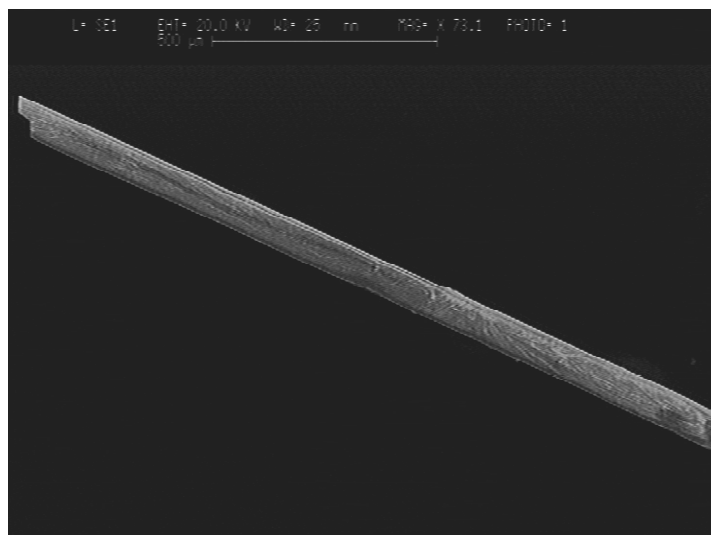
Abbildung 105: Elektronenmikroskopische Aufnahme eines Cs[AuCl_4] -Kristalls
