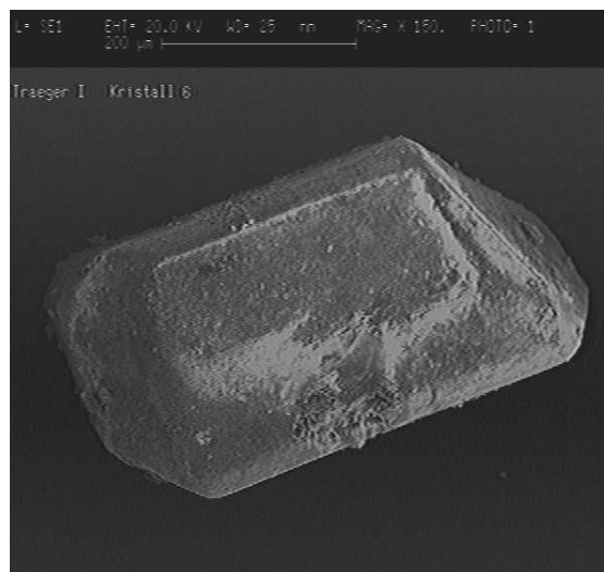
Abbildung 29: Elektronenmikroskopische Aufnahme eines \text{Cs}_2[\text{PdBr}_4]\text{I}_2 -Kristalls
