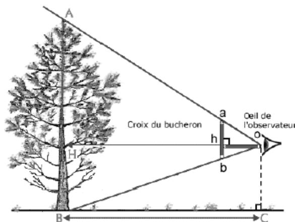
Lorsque les deux extrémités de l'arbre correspondent bien aux deux extrémités du bâton, mesure la distance entre tes pieds (à l'aplomb de ton œil) et la base de l'objet.  $BC = \dots\dots\dots$
